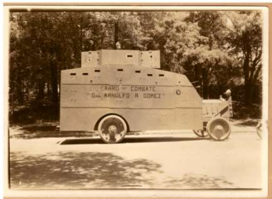
Carro de combate equipado con lanzallamas, primer arma combinada que también servía de base para realizar comunicaciones inalámbricas, diseñado por el General de División Arnulfo R. Gómez.
